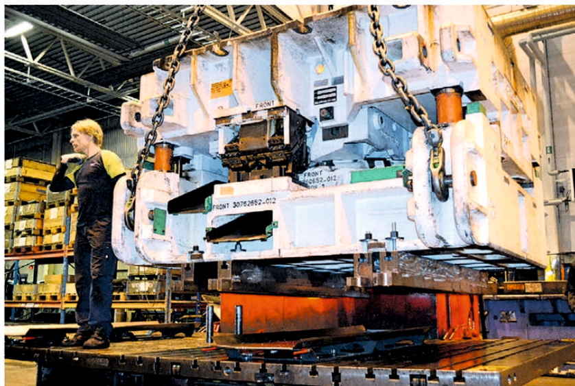
Det stora pressverktyget i EBP:s produktionsanläggning sänks ner över utmatningsenheter.
