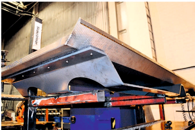
Conveyor 22 tog fram Quick Cassette med insatsfäste, transportör och ränna, vilket var den lösning som krävdes för att EBP skulle kunna ta hem jobbet. Att pressa 50 gånger för att sedan stanna och rensa skrot hade gjort hela affären olönsam.
